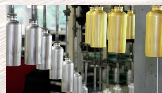
1. Pulverbeschichtung mit extra angereichertem Goldron.
